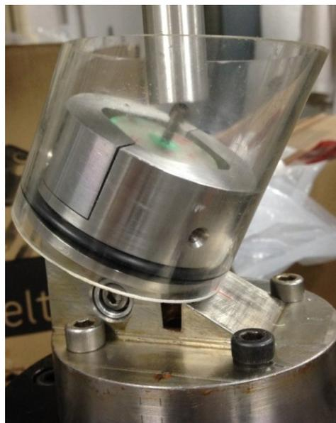
*Figura 3-5 Imagen fotográfica del montaje final del implante ensayado dentro de las mordazas de fatiga.*
