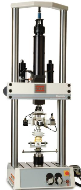
Figura 3-1 Máquina de ensayos mecánicos Bionix-370 (MTS, USA) utilizada para el ensayo de compresión.
