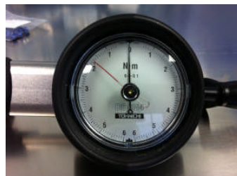
Figura 2: Torquímetro TOHNICHI modelo DB6N4
