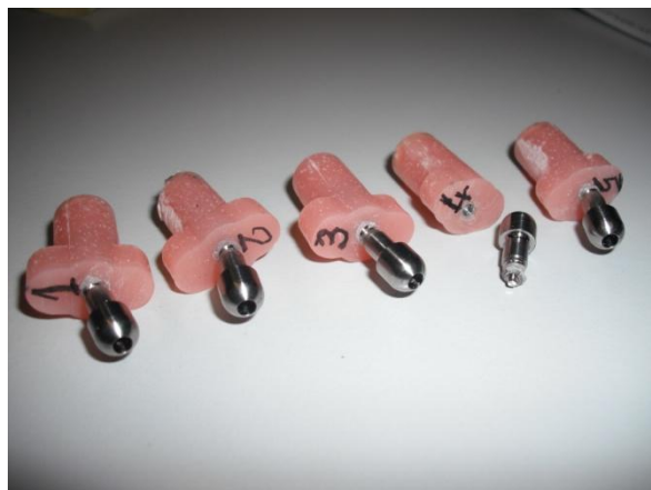
Figura 5. Muestras tras el ensayo a resistencia estática.
