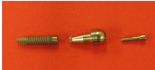
Figura 1. Conjunto pilar/cuerpo de carga, tornillo de conexión e implante de conexión interna cónica.
